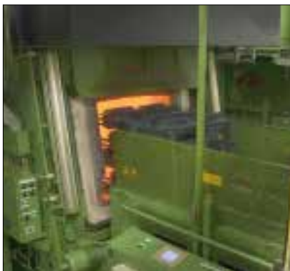
グラファイト断熱材を使用した加熱室 写真: Schmetz GmbH Vacuum Furnaces, Germany
