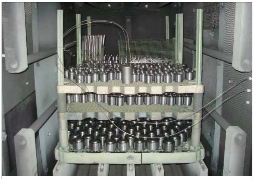
熱電対の使用により熱処理中のエア毎の温度分布が得られる。 写真: voestalpine High Performance Metals CZ s.r.o.
