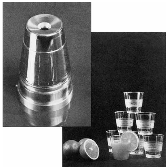
制造一次性聚苯乙烯杯子的Stavax ESR型芯, 该模具已生产了几百万个同精度公差的高表面质量产品
